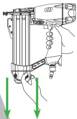
**Enfoncer** le bouton de verrouillage du chargeur et tirer pour ouvrir le chargeur.
