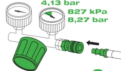
**Conecte** la manguera de aire a la salida del regulador. **Ajuste** la perilla reguladora para que la presión de salida sea de entre 4,14 bar y 8,27 bar (60 psi y 120 psi).
