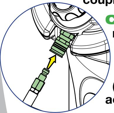
**Conekte la manguera de aire con tapón industrial de 6,4 mm (1/4 pulg.) al acoplador.**
