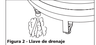
Figura 2 - Llave de drenaje
