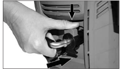
Figure 8 - Attachez le tuyau d'arrosage à l'unité
