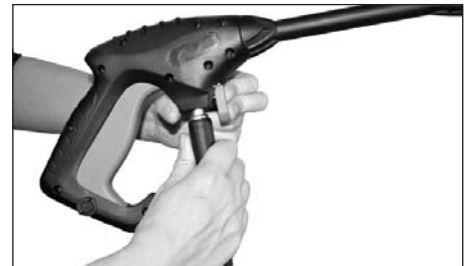
Figura 5 - Conecte la manguera de alta presión a la pistola (todos los modelos)
