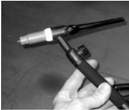
Figure 5- Installaton de coupelle de retour
