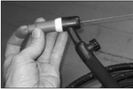
Figure 4 - Tungstène doit sortir de 3/16 po
