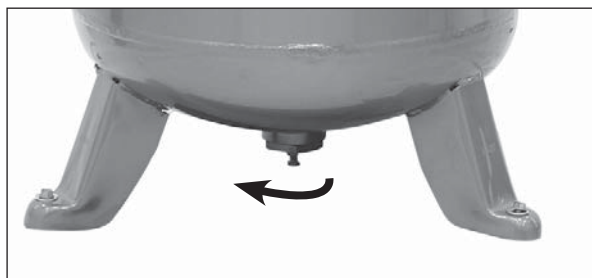
Figure 8 - Drain de réservoir manuel
